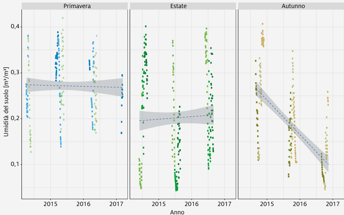
FIG. 25: Mentre in primavera e in estate non sono riscontrabili variazioni, il contenuto idrico del suolo si è ridotto sensibilmente negli ultimi tre anni. Tuttavia, per poter fornire previsioni più a lungo termine, la serie di misurazioni dovrà continuare ancora per molti anni. (Dati, elaborazione e rappresentazione: Eurac Research)
