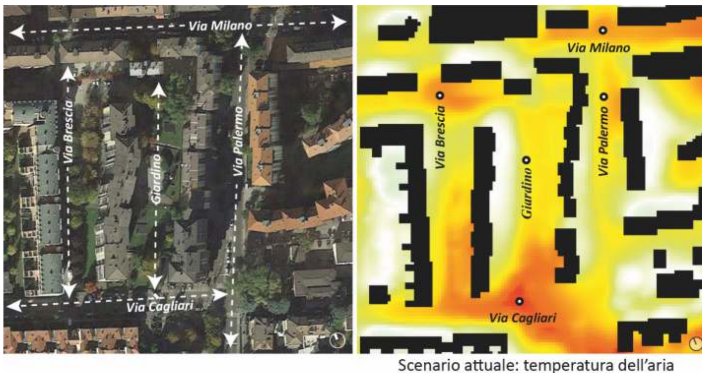
Figura 2 : Esempio delle analisi microclimatiche svolte sul quartiere Via Brescia e Via Palermo a Bolzano. Vista aerea (a sinistra), mappa delle temperature alle 15:00 di una tipica giornata estiva (in centro) e benefici derivanti dall'integrazione delle infrastrutture verdi (a destra). Elaborazione EURAC (Croce, Vettorato 2018)
