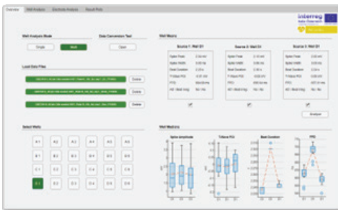
Screenshots vom INCARDIO MEA-Signalanalyse-Tool, das aus Gründen der Benutzerfreundlichkeit ausschließlich mit der Maus bedient werden kann und keine manuelle Eingabe der Analyseparameter erfordert
