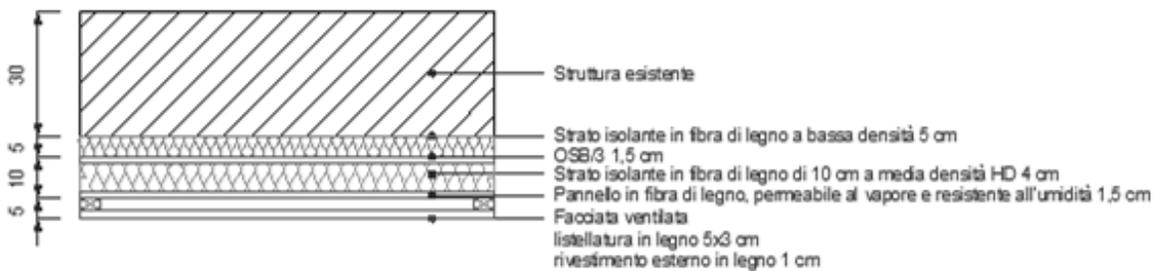
Figure 2 Pannello con strato irrigidente in OSB e facciata ventilata
