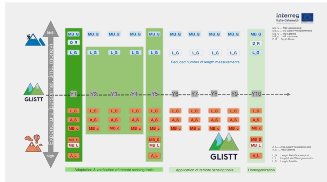
Figura 10: Schema concettuale del primo periodo di implementazione del concetto di monitoraggio dei ghiacciai sviluppato in GLISTT. Per un orizzonte temporale di 10 anni, da Y1 a Y10, nella parte superiore del grafico sono riportate le misure di monitoraggio tradizionali mentre in quella inferiore sono evidenziate le applicazioni di telerilevamento. La freccia in entrambe le direzioni segnala il generale aumento delle risorse da impiegare.
