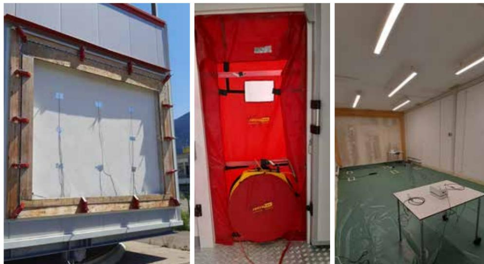
Figura 11: Sensori di facciata (sinistra), Blower-door-test (centro), disposizione dei sensori per il test di valutazione dell'ambiente (destra)
