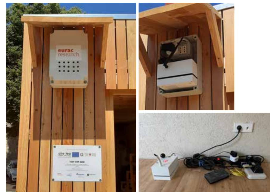
Figura 12: Dispositivi di monitoraggio multi-parametro all'interno (a) e all'esterno (b) del *Tiny FOP MOB*
