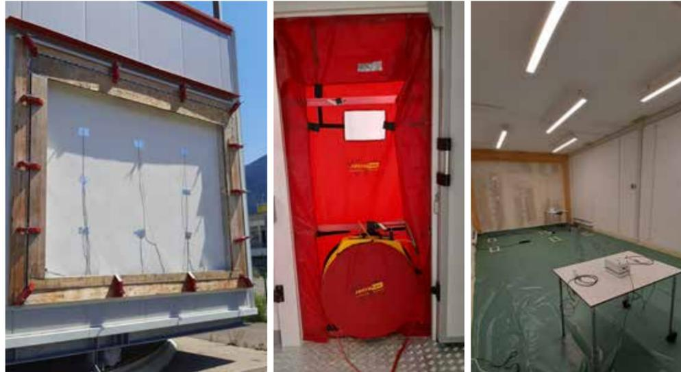
Abbildung 11: Fassadensensoren (links), Blower-Door-Test (Mitte), Anbringung der Sensoren für die Messung des Raumklimas (rechts)
