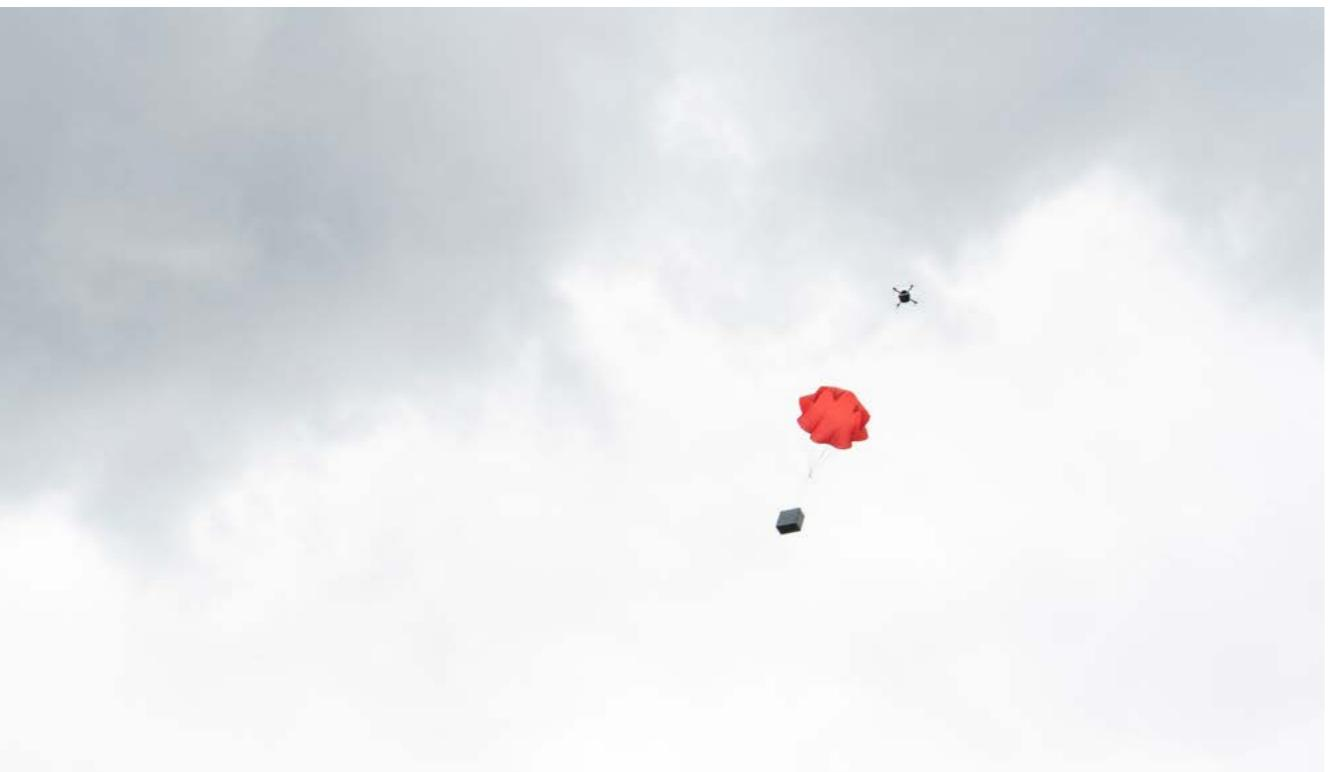
Die Drohne trägt ein Paket für die Erstversorgung. Es wird keine zehn Meter vom Unfallort abgeworfen, ein kleiner Fallschirm bremst den freien Fall.
