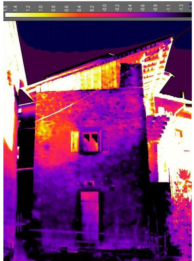
Die Thermografie eines Gebäudes macht sichtbar, wo Wärme entweicht. Sie ist eines der Instrumente, mit denen die Energieexperten von Eurac Research den Ortskern von Madruzzo (Trentino), aus dem 16. Jahrhundert, einer eingehenden Diagnose unterziehen, um das **Potenzial für eine energetische Sanierung** zu bemessen.
