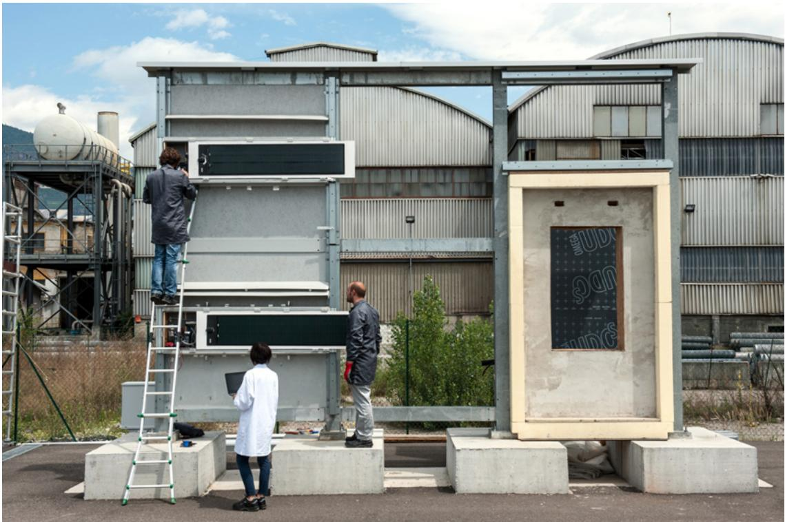
Das **PV Integration Lab** im NOI Techpark, seit Juli 2017 in Betrieb, besteht aus einem Fassadenmodell und einem Dachmodell, das alle Neigungswinkel reproduzieren kann. (Foto: Ivo Corrà)
