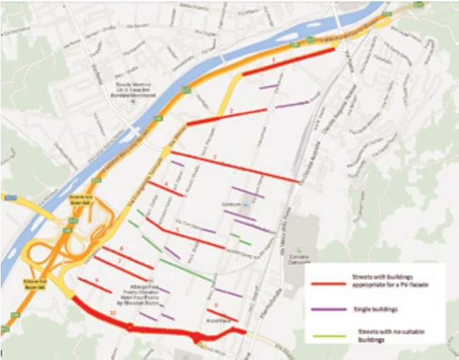
Abbildung 8: Straßen in der Bozner Industriezone mit als für PV-Systeme an Fassaden geeignet eingestuft Gebäuden
